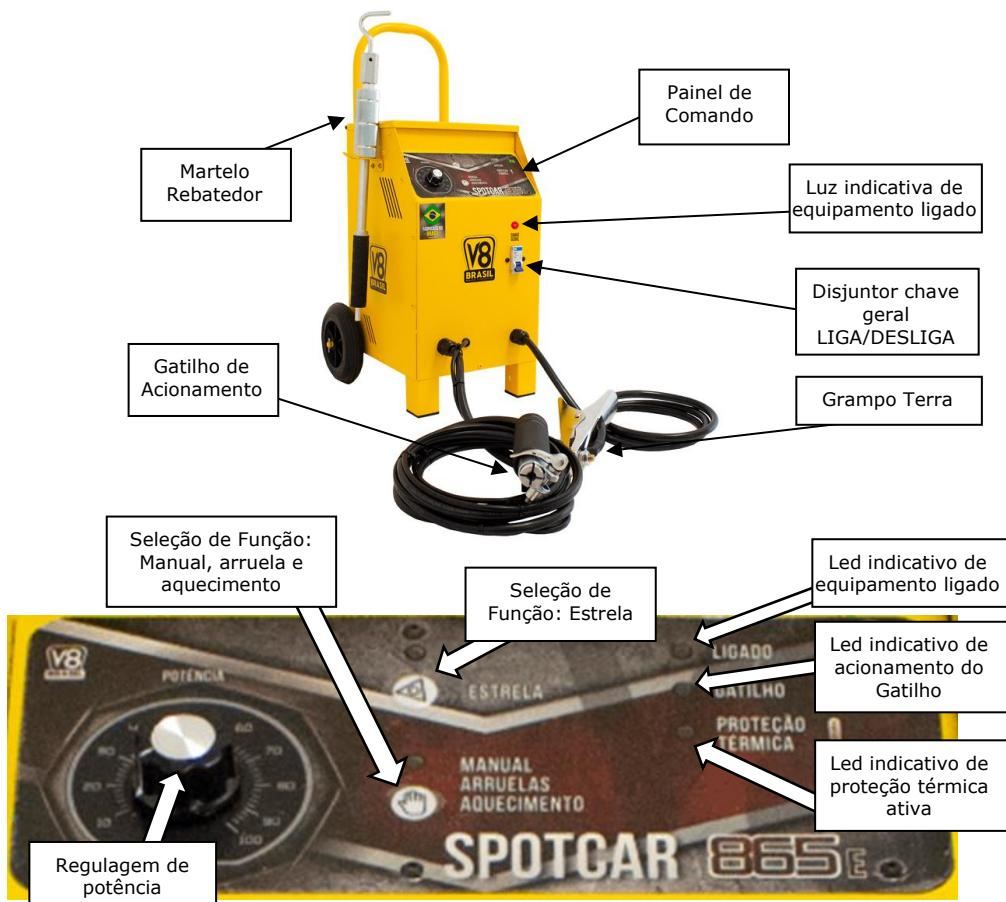
O usuário necessita ajustar a potência, conforme a necessidade de uso. Por exemplo, se uma chapa fina necessita de rebatimento, recomenda-se a começar pelo ajuste de menor potência e ir gradualmente aumentando a potência. Para o rebatimento de uma chapa grossa, recomenda-se utilizar a potência de 50 até 100.
