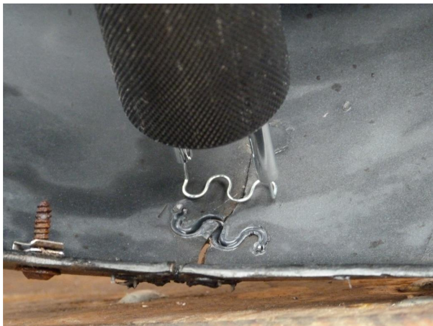
PARAFIX sendo usado no conserto do para-choque
